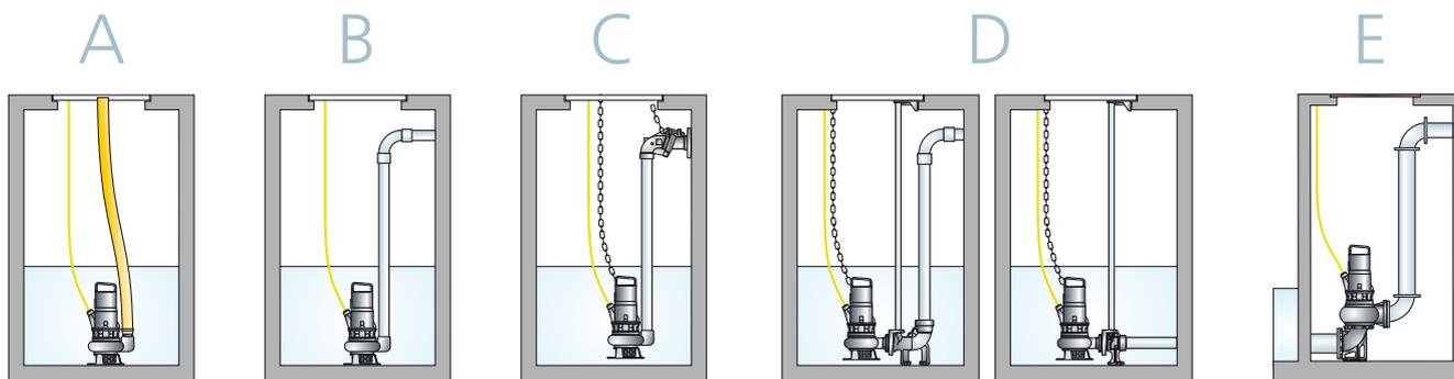
СУХАЯ установка разрешается в режиме S3 на моделях с всасывающим фланцем. За более подробной информацией обращайтесь в Отдел работы с заказчиками.
