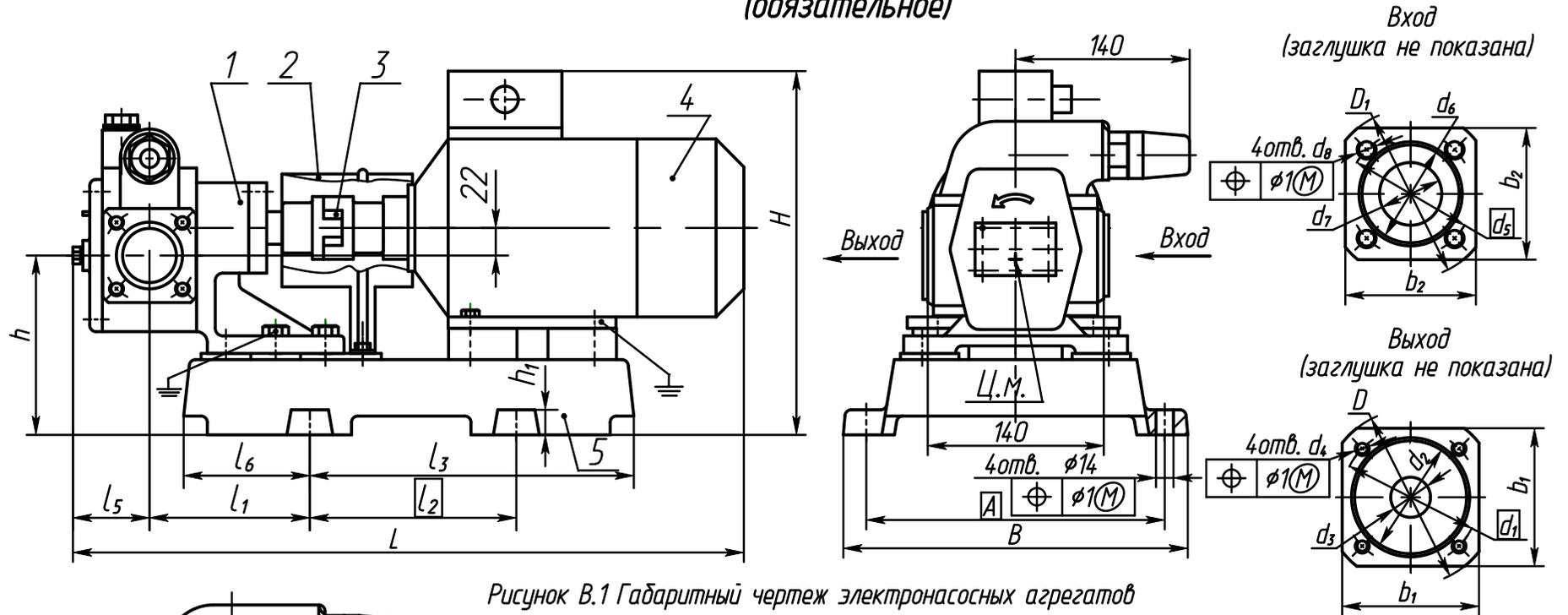
Рисунок В.1 Габаритный чертёж электронасосных агрегатов
